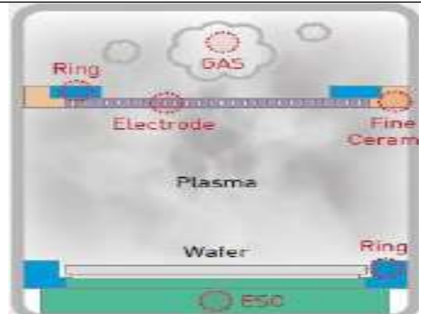
그림 2. 반도체 Dry Etching(식각) Chamber 구조
