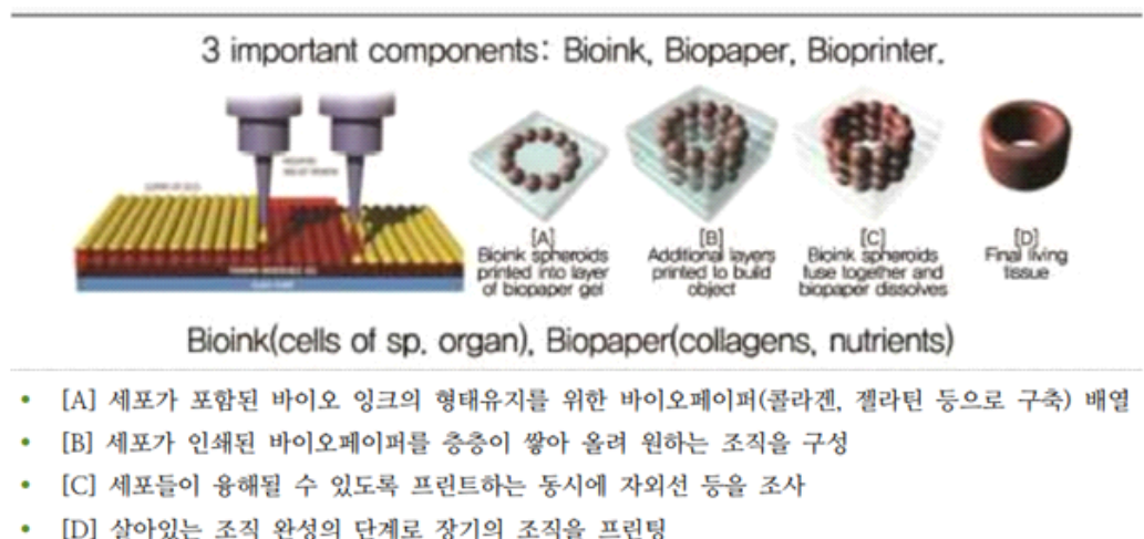
[그림 11] 바이오잉크를 이용한 3D 바이오프린팅 프로세스
