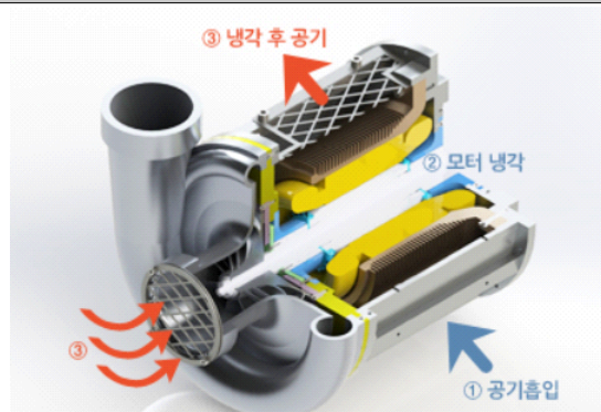
[그림23] 터보블로워 전동기 공냉 예시
