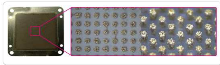
[그림28] 동사의 0.1mm 이하 피치 대응 실리콘 러버형 소켓 제품
