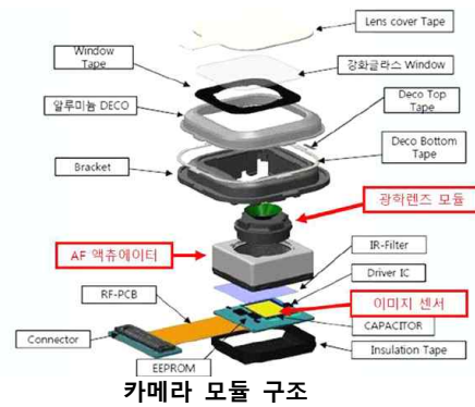
[그림 9] 휴대폰용 카메라 모듈 구조 및 완성품
