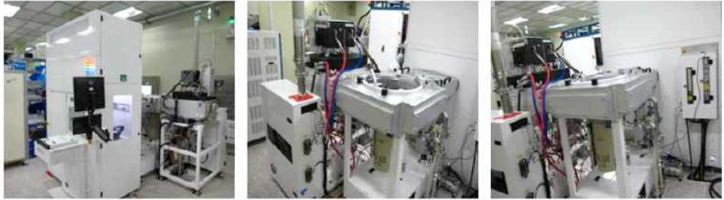
[그림 14] 동사가 개발한 450mm 웨이퍼용 PECVD ACL 장비
