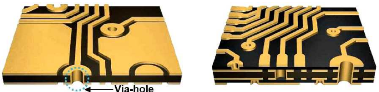
[그림 4] 양면 PCB(좌)와 다층 PCB(우)
