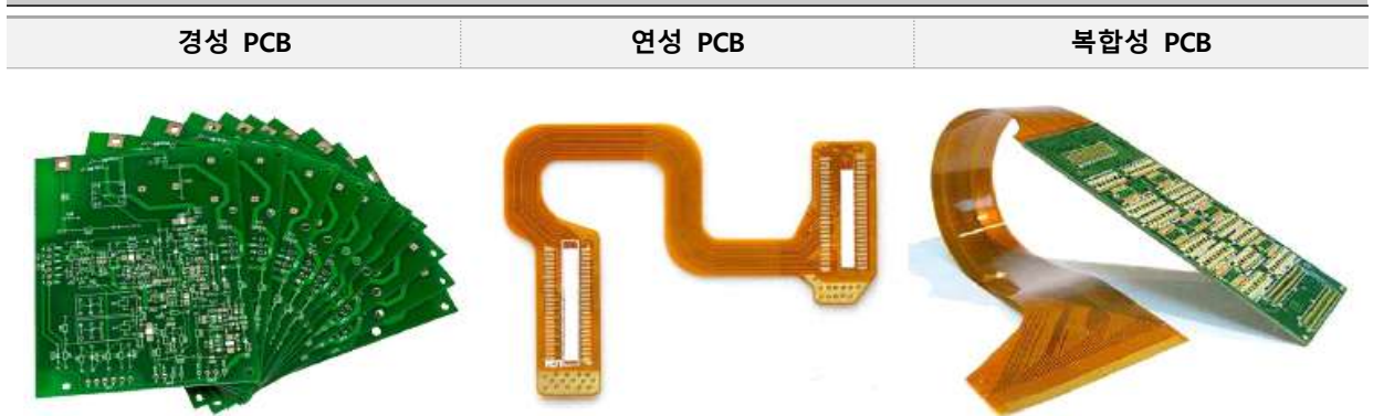
[그림 7] 재질 및 굴곡성에 따른 PCB 분류
