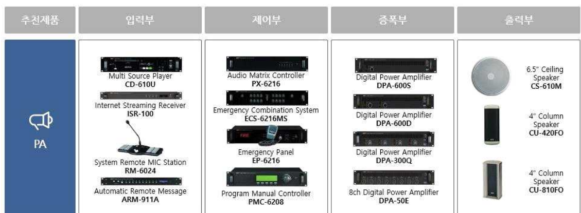
[그림 12] PA System 블록다이어그램 예시
