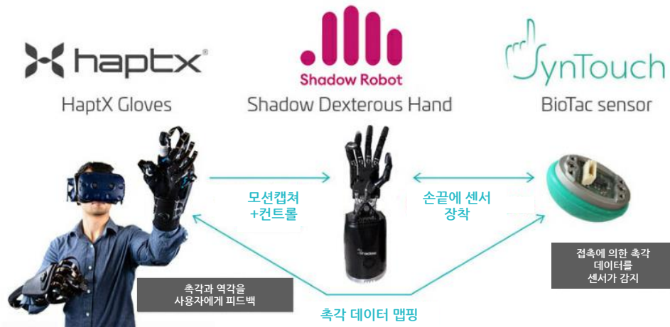
도표 34. 햅틱 기술과 모션 캡처 기술을 조합한 원격 조종 로봇 핸드
